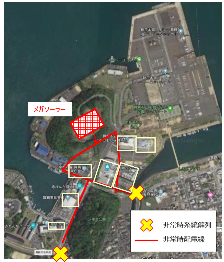
・非常時に電力が供給される主な施設と導入設備
