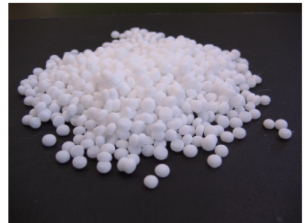
PCMが日射熱を放熱すると、固相に戻ります
