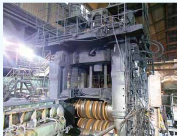
形鋼BDミルの改造(スラブを圧延するために必要な3つの改造) BDミル耐荷重UP +500t BDロールリフト量UP +400mm BDロール胴長 +200mm
