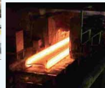
形鋼BDミルの改造(スラブを圧延するために必要な3つの改造) BDミル耐荷重UP +500t BDロールリフト量UP +400mm BDロール胴長 +200mm
