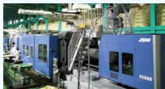
1. 電動式射出成形機 (1,800t, 1,300t, 180t, 100t)
