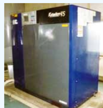
1. インバータ式コンプレッサー 吐出量6.55m 3 /min.以上、吐出圧0.7MPa
